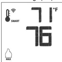
Pour ajuster la température réglée, appuyer sur les touches flèche haut ou bas jusqu'à ce que la température réglée désirée soit affichée sur l'écran ACL de l'émetteur.
